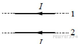
10. По двум тонким прямым проводникам, параллельным друг другу, текут одинаковые токи  $I$  (см. рисунок). Как направлен вектор индукции создаваемого ими магнитного поля в точке  $C$ ?
